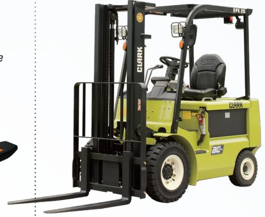
**특징** | 기존의 지게차에 수리나 개조없이 Scale을 장착 | 정밀도 향상을 위한 전자수준기(Level Sensor) 기본장착 | 계량과 목적지 이동을 동시에 함으로써 작업간 절약 | 저울의 기능과 운반의 기능을 겸함 | 무게값 프린터 기능(선택사항)
