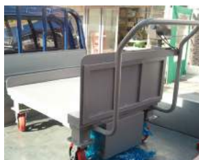
충전형 대차스케일 주문제작 설치사례
