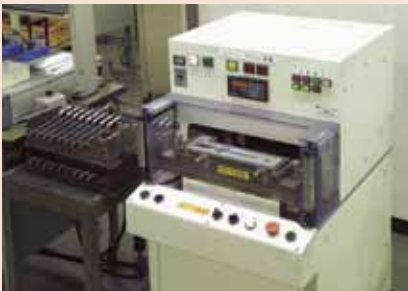
ABS 방수 캘리퍼스용 공기 누출 시험 장비
