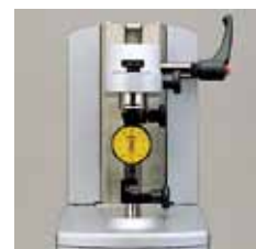
테스트 인디케이터 부착 세트(02ASK000) 사용
